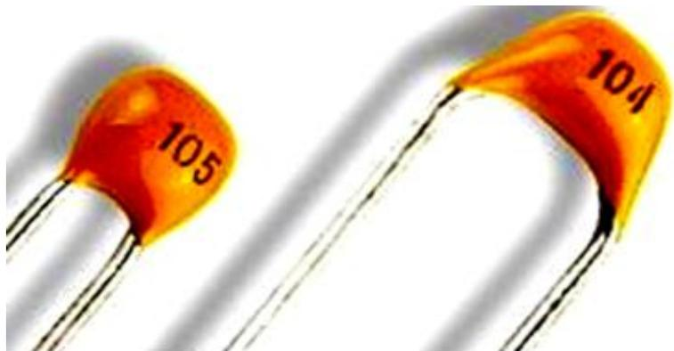
独石电容器实际上是一种瓷介电容器，外形具有独石形状，相当于若干个小陶瓷电容并联，容量大、体积小，是小型陶瓷电容器。它具有电容量大、体积小、可靠性高、电容量稳定，耐湿性好等。
