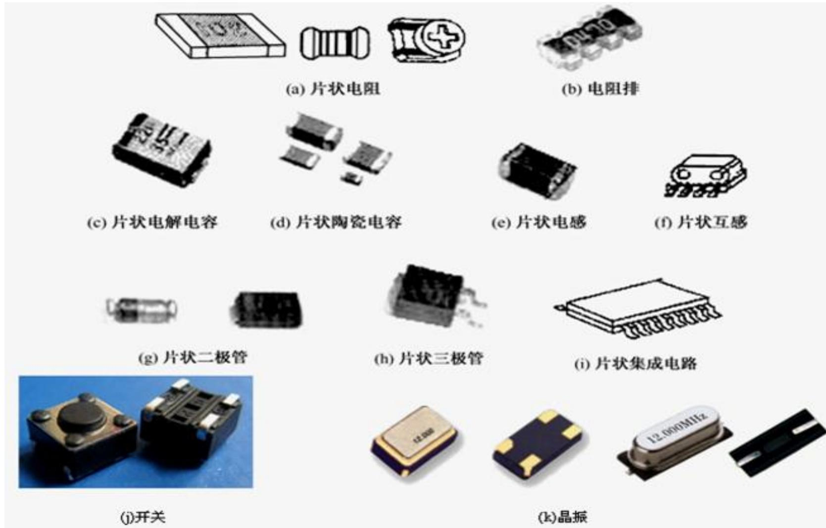
部分常用表面安装元器件的外形结构
