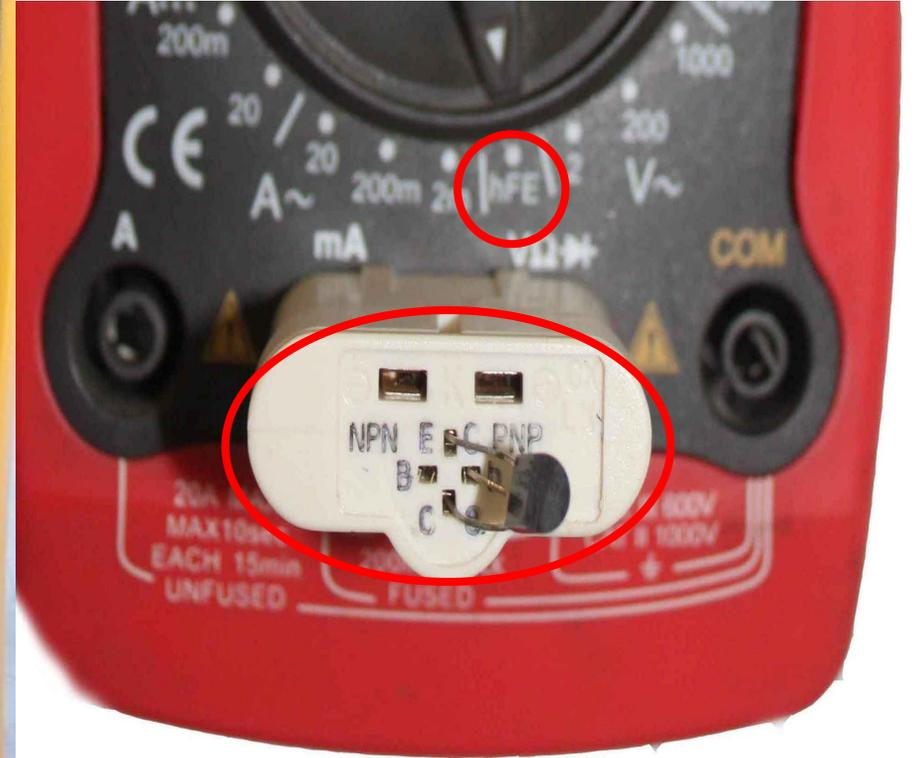
在显示屏右上角有个插三极管的地方（或外接），假设三极管可能是**PNP**型的，则将三极管插入**PNP**的一排插口中，改变三个脚插入不同的孔，如果发现都是**0**示数,则插错了。
