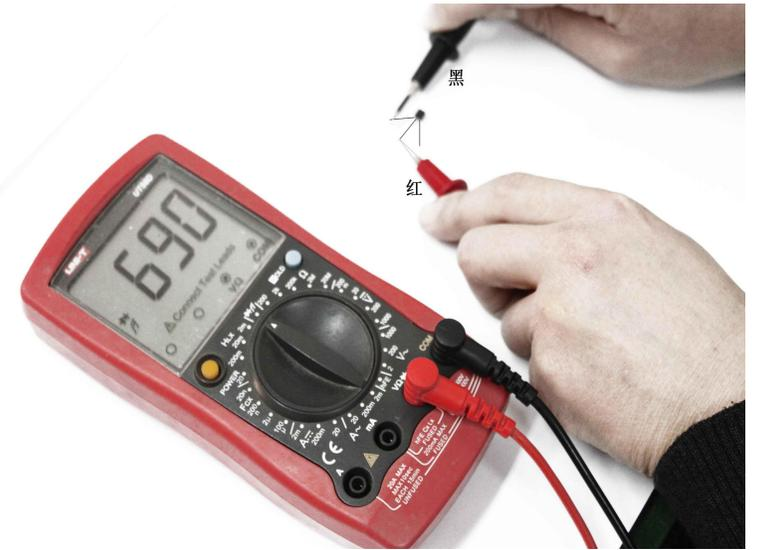
③ **看材料** 当检测到两次显示值均小于1V时，观察万用表的示数，即三极管的正向压降，如果示数在300 (0.3V) 左右，则该三极管的材料为**锗**三极管；如果示数在700 (0.7V) 左右，该三极管的材料为**硅**三极管。
